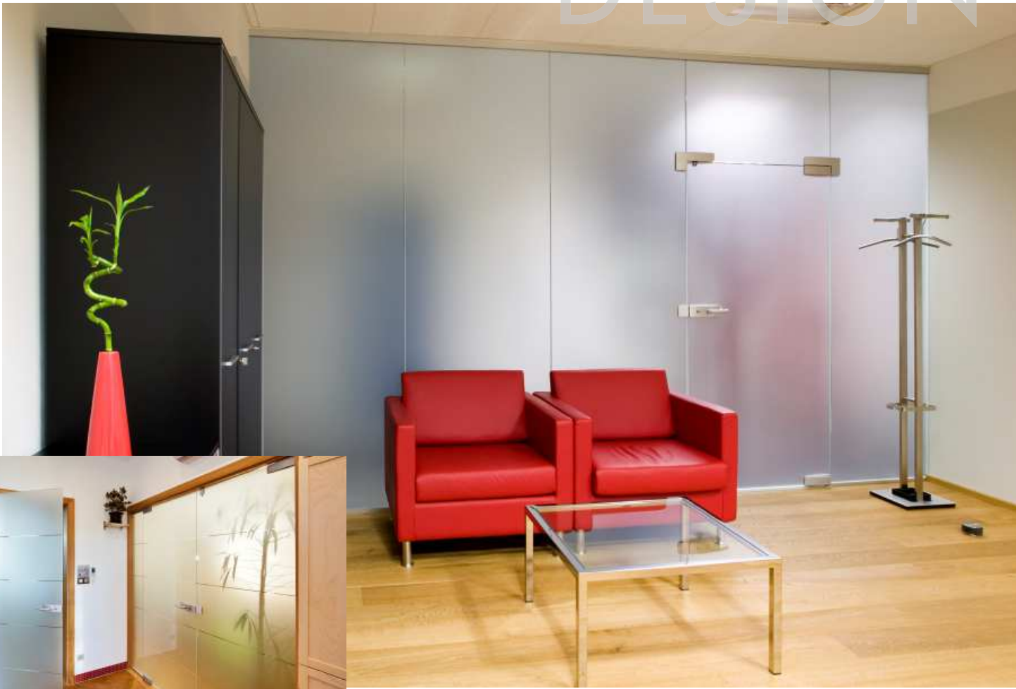
Jednokřídlé otočné dveře s nadsvětlíkem a bočními fixními skly, sklo: Satináto bílé, kování: Arcos Universal PT
