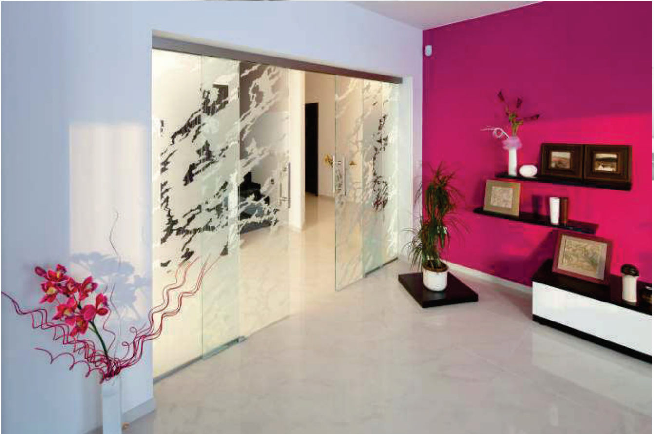
2-křídle posuvné dveře na 2x BS, stavební otvor: 2660/2084 mm, sklo: Float čirý 10 mm, dekor S C07 P+N, kování: Agile 150 + madlo MD 01
