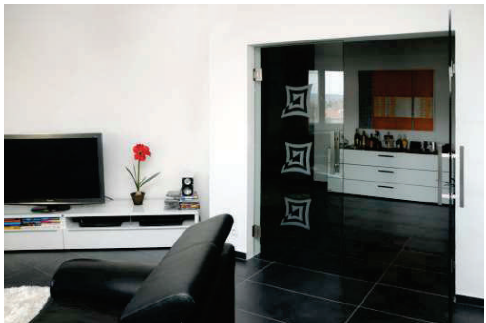
2- křídle kyvné dveře, stavební otvor: 1800x2000 mm, sklo: Float čirý 10 mm, vzor: VS P3P, kování: Biloba 107+ madlo MD 03
