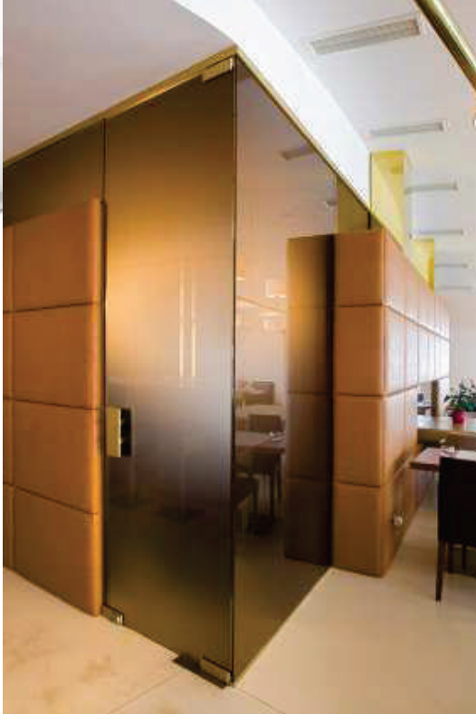
1-křídle kyvné dveře 900/2800 mm s BS usazené v nábytkové stěně, sklo: Satinátó bronz 10 mm, kování: Universal PT + podlahový zavírač BTS 75 V + zámek US 10 + madlo - atyp + čep do stropu
