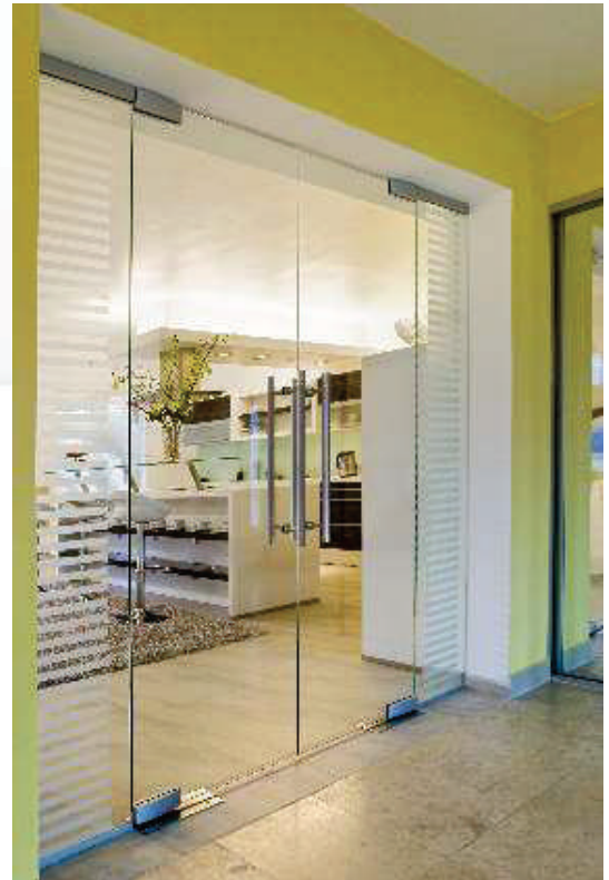
2-křídle kyvné dveře 1600/2200 mm (dělení 800 + 800 mm) s 2x BS, stavební otvor: 2500/2200 mm, sklo: Float čirý 10 mm, vzor: S M19P na boční světílík, kování: zavírač BTS 75 V + Arcos Universal PT + madlo MD 01 + čep do stropu
