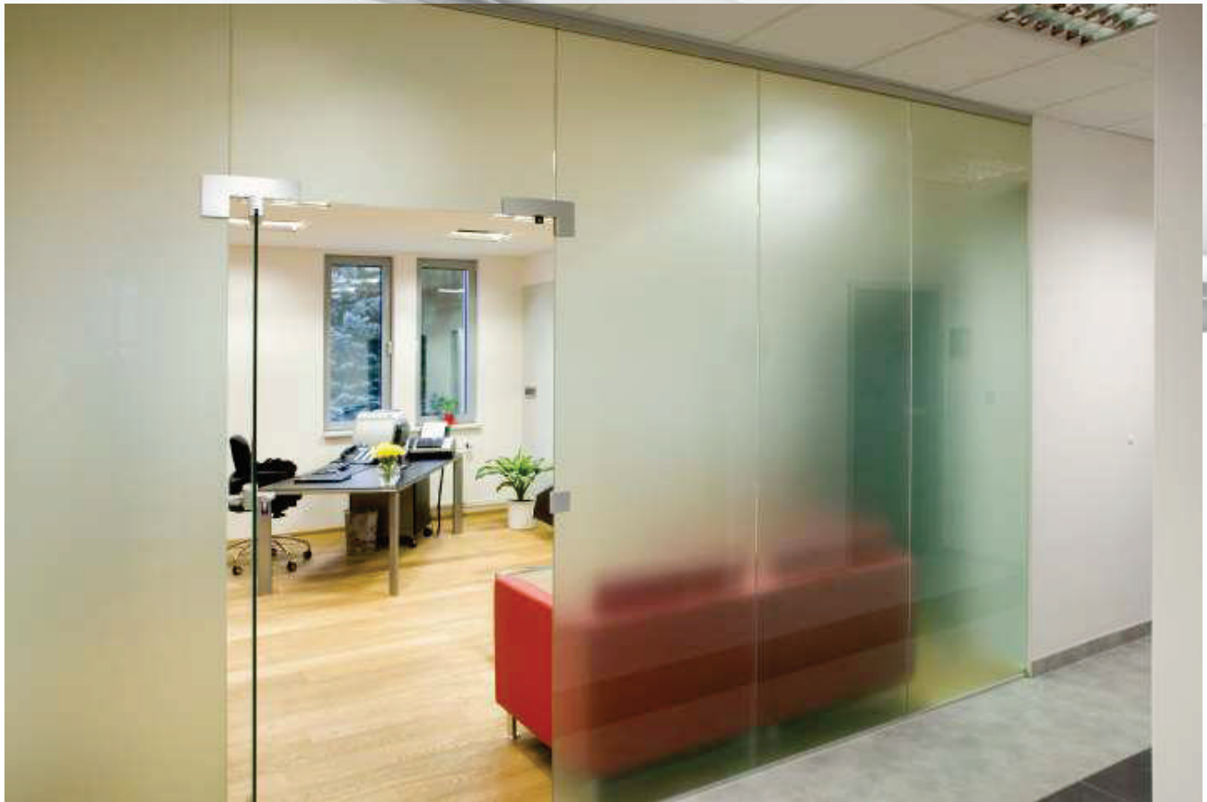
1-křídlé otočné dveře 970/1970 mm s 4x BS a NS, stavební otvor: 4250/2620 mm, sklo: Satinát bílý 10 mm, kování: Arcos 03/114 + Arcos Universal PT + protikus + čep do podlahy
