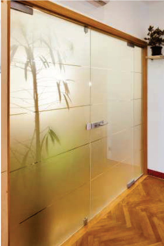
2-křídle otočné dveře 900 + 800/2200 mm do průchozí obložkové zárubně s bočním světlíkem, průchod zárubní: 2000/2200, sklo: Satináto bílé 10 mm, vzor: gravír - atyp, kování: Arcos 03/114, protikus, západky + panty Arcos Universal PT
