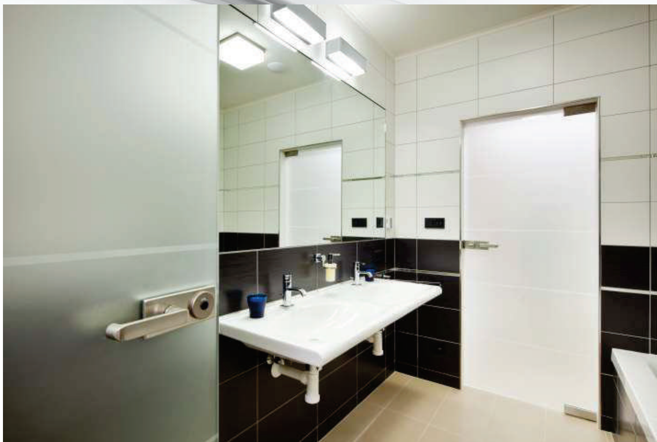
1-křídle otočné dveře 800/2050 mm do stavebního otvoru, sklo: Satinát bílý 10 mm, vzor: pískování - atyp, kování: Classic 05/107 + klika Rondo + protikus + Universal PT + čep do podlahy a do stropu
