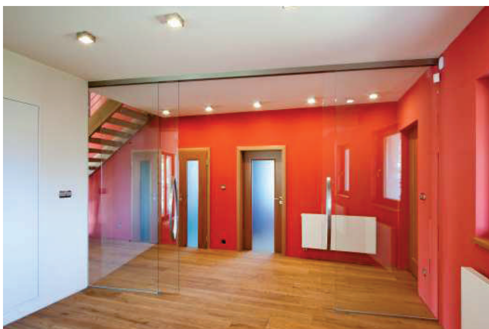
2-křídle posuvné dveře na 2x BS, stavební otvor: 2660/2084 mm, sklo: Float čirý 10 mm, kování: Agile 150 + madlo Arcos 750
