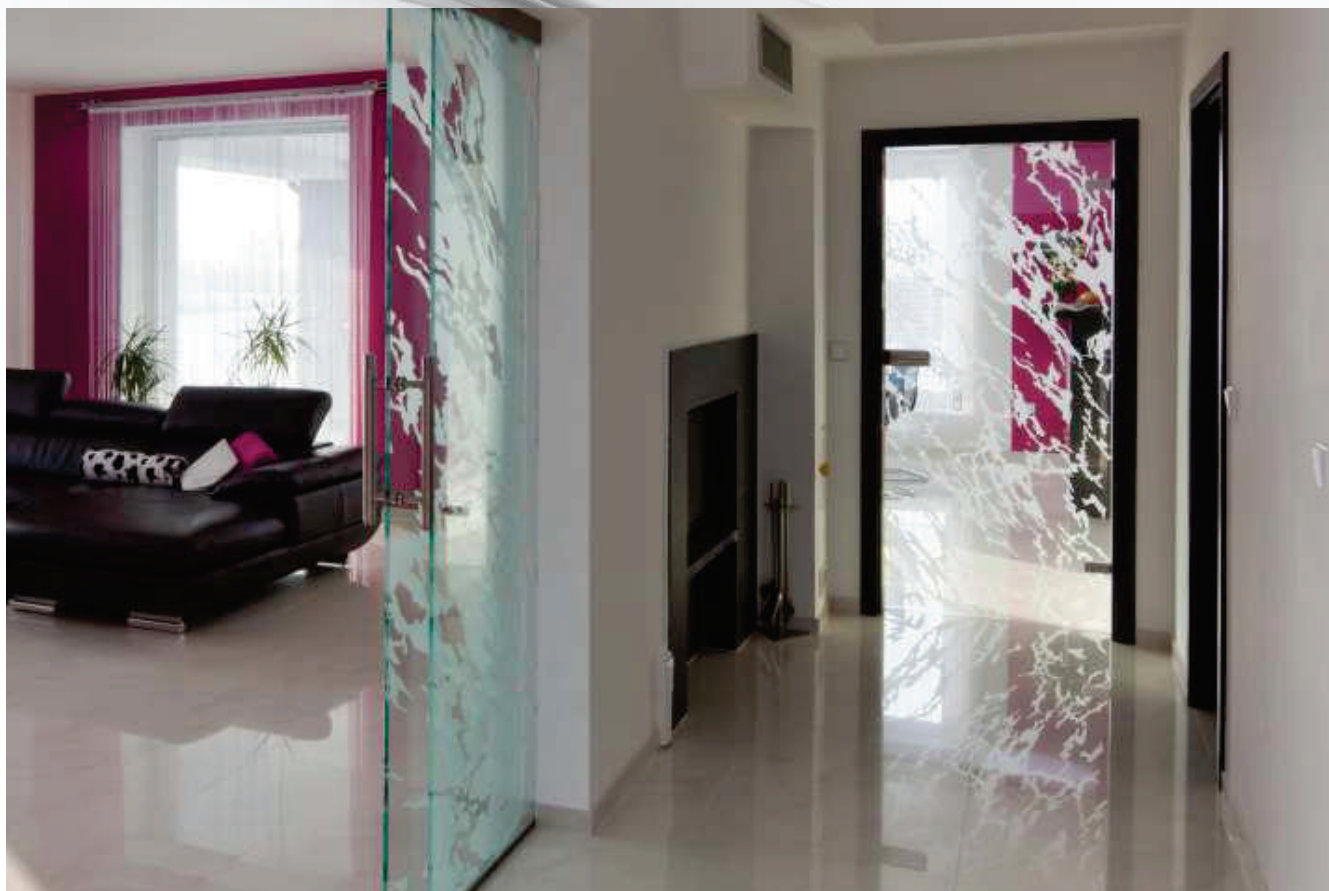
vpravo: 1-křídle otočné dveře 800/1970 mm do obložkové zárubně, sklo: Float čirý 8 mm, vzor: S C07P, kování: Arcos 01/107
