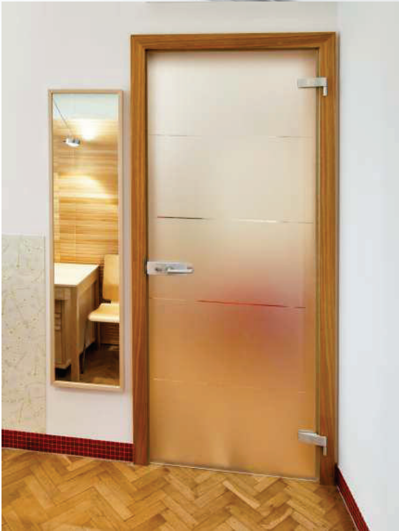
1-křídle otočné dveře 800/2200 mm do obložkové zárubně, sklo: Satináto bílé 8 mm, vzor: gravír - atyp, kování: Arcos 03/114
