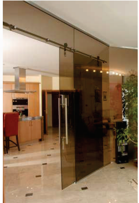
1-křídle posuvné dveře s NS na BS + fixní stěna, stavební otvor: 2920/2670 mm + 2400/2670 mm, sklo: Planibel bronz 10 mm, kování: Manet 5.1 (nerez brus) + MD 01 atyp
