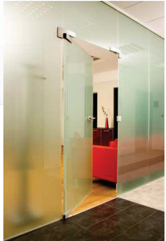
1-křídle otočné dveře 970/1970 mm s 4x BS a NS, stavební otvor: 4250/2620 mm, sklo: Satínato bílé 10 mm, kování: Arcos 03/114, Arcos Universal PT + protikus + čep do podlahy
