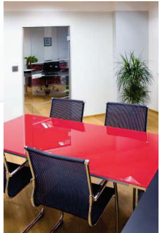
1-křídle otočné dveře 800/1970 mm do hliníkové zárubně AT 23E, sklo: Float čirý 8 mm, vzor: pískování - atyp, kování: Arcos 03/114
