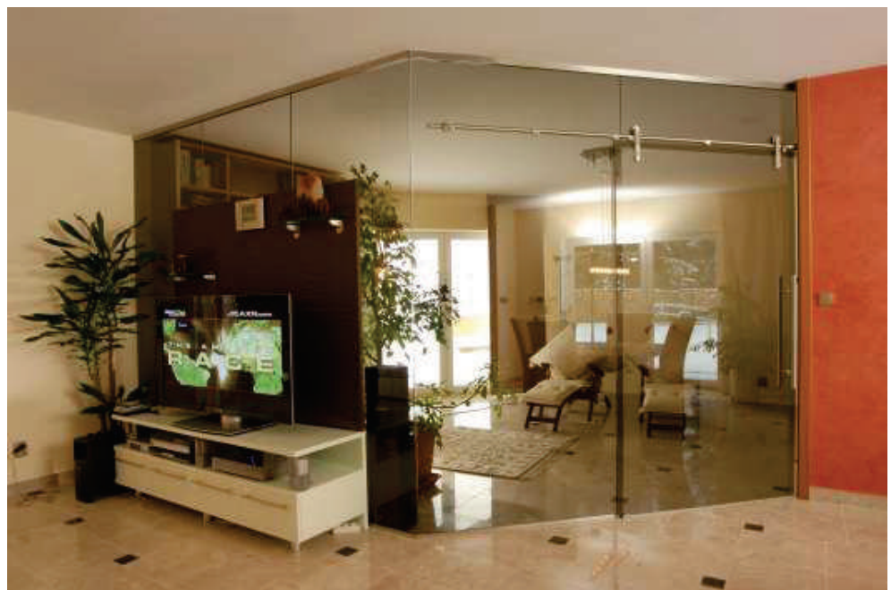
1-křídle posuvné dveře s NS na BS + fixní stěna, stavební otvor: 2920/2670 mm + 2400/2670 mm, sklo: Planibel bronz 10 mm, kování: Manet 5.1 (nerez brus) + MD 01 atyp
