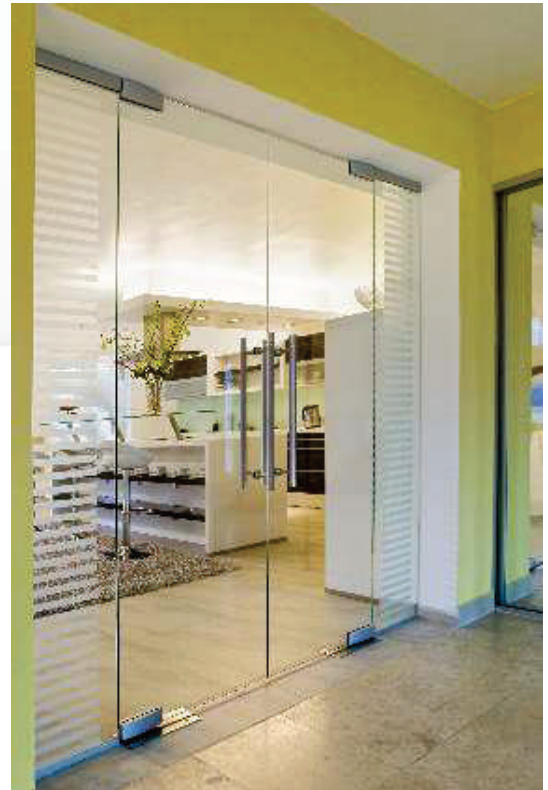
2-křídle kyvné dveře 1600/2200 mm (dělení 800 + 800 mm) s 2x BS, stavební otvor: 2500/2200 mm, sklo: Float čirý 10 mm, vzor: S M19P na boční světlík, kování: zavírač BTS 75 V + Arcos Universal PT + madlo MD 01 + čep do stropu
